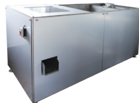
ゴルフボール洗浄機 3000-S 3相 200V 1,800×700×H900／110kg 処理量2万個／h 洗浄用ブラシ 円盤ブラシ1枚 乾燥ブラシ9本／乾燥ファン1台
